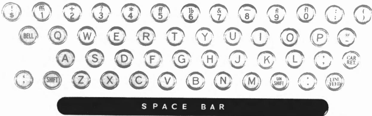
TYPICAL KEYTOP ARRANGEMENT — TELETYPE MODEL 20 PRINTER
