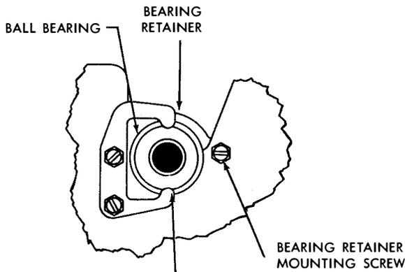
(B) CAM-SHAFT BEARING RETAINER
