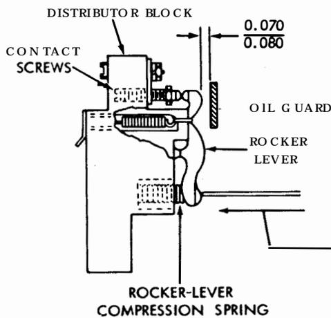
NOTE 2-- WITH DISTRIBUTOR BLOCK REMOVED ADJUST CONTACTS SO THAT THERE IS 0.070 TO 0.080 INCH BETWEEN ROCKER LEVERS AND OIL GUARD.
