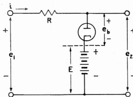
Fig. 3. Diode clipper.
